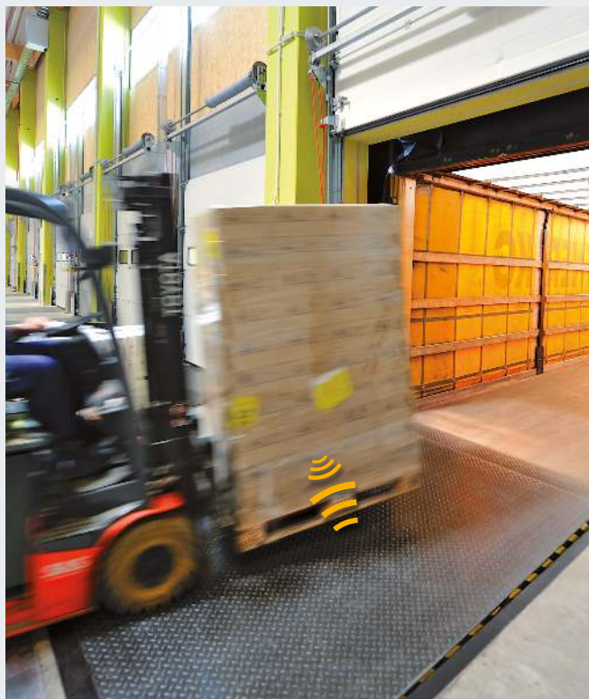
Automatisches Erfassen von Warenbewegungen, einfach beim Überfahren der Ladebrücke.
