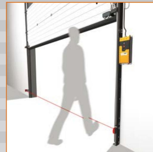
boîtier de contrôle tandis que sur le rail d'en face est monté un réflecteur ou un récepteur. Si le rayon entre l'émetteur et le réflecteur/récepteur est interrompu par un objet, un signal est donné au moteur afin d'inverser immédiatement le mouvement de la porte. Le système à réflecteur est toutefois plus sensible aux poussières et à l'humidité, contrairement à la version avec récepteur.
