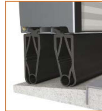
Pour une fermeture optimale en partie basse Alpha utilise un joint bas double à lèvres incurvés vers l'intérieur. L'utilisation de ce joint bas double avec un profil spécial en plastique assure une conduction thermique plus faible.
